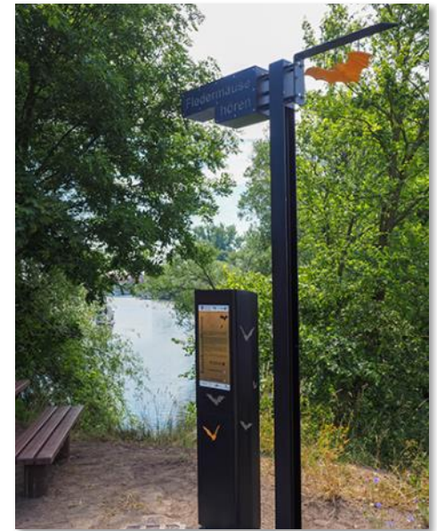
Stationärer Fledermausdetektor (Horchstation) an der Brücke zur Havelberger Spülinsel.
